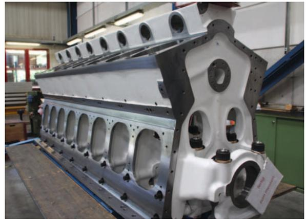
Im Werk Altdorf hat man sich auf die Bearbeitung von Werkstücken in XXL spezialisiert – hier ein Großdieselmotor.
